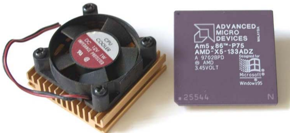
Procesor AMD X5 s frekvencí 133 MHz a aktivní chladič
